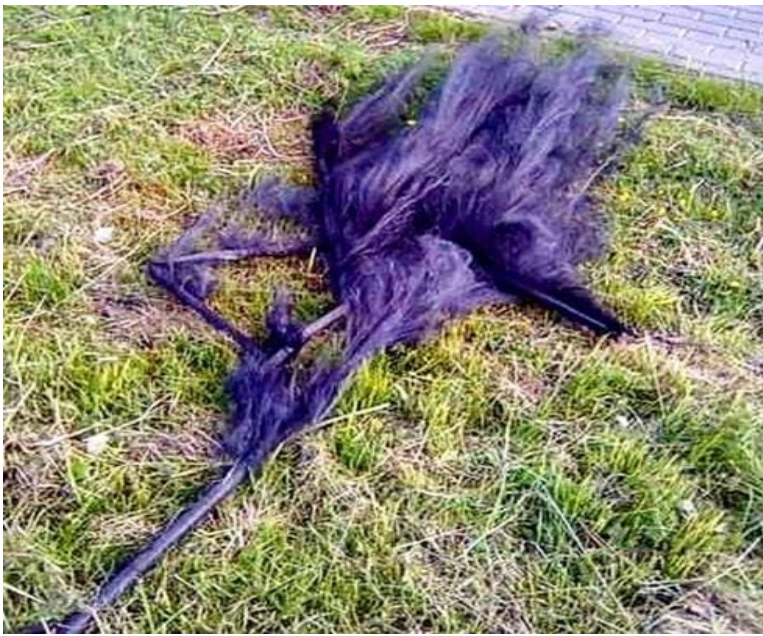
Углепластиковая удочка, после воздействия электрического тока.
